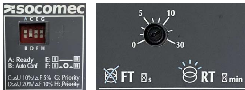
Abbildung 2: Einstellmöglichkeiten Netzumschalter (DIP-Schalter / Potenziometer)
